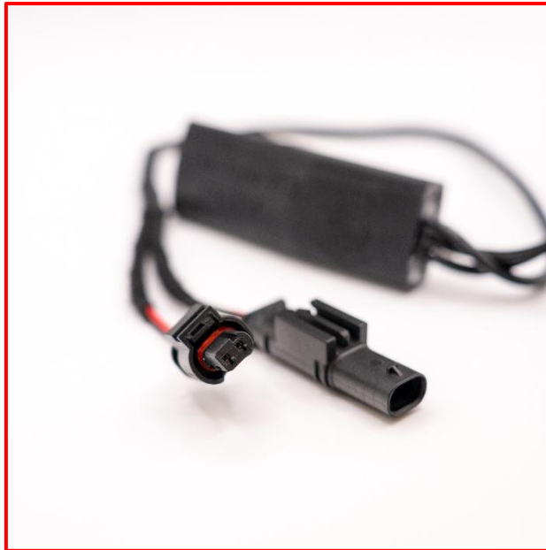
Steckverbindungen für Schritt 3: Steckverbindung der Bordsteckdose
