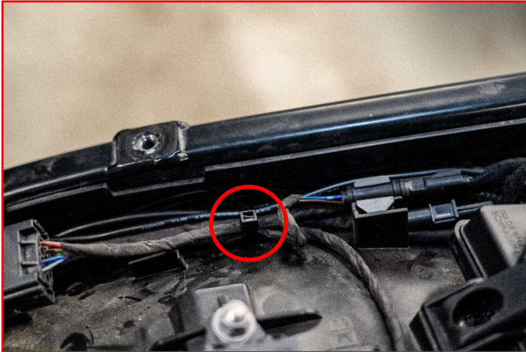
Die zur Motorradbatterie führenden Leitungen mit einem Kabelbinder am Motorradkabelbaum befestigen. (Kreis).
